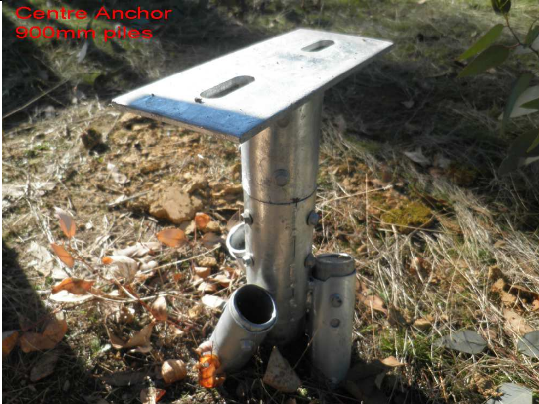
Anchor Test 900mm Piles 2000KG Load
